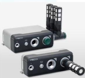
積層可能構造で、-94kPaの高真空、最大1,110ℓ/min[ANR]の大吸込流量を確保する多段ノズルエジェクタです。吸込流量はエア消費量の平均約2.2倍を確保しました。自動車、半導体、食品、薬品分野はもちろん、一般産業など様々な分野に最適です。取出方向は側面、前面、回転型の3種類をご用意しており、設置スペースに合わせて選択可能です。メーカーにてデモ機をご用意しておりますので、小型で大流量の真空発生器VLMシリーズを、是非一度お試しください！
